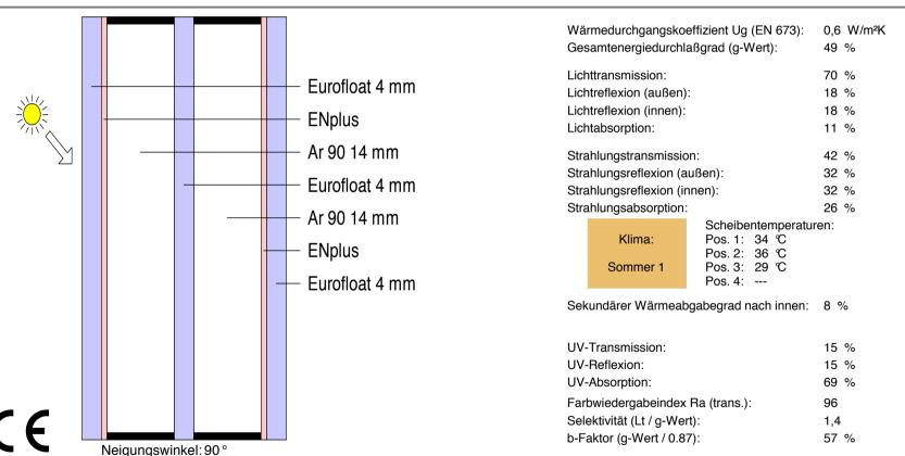
Die angegebenen Werte werden gemäß den europäischen Normen EN 410 und EN 673 berechnet und basieren auf Prüfdaten. Durch Produktionstoleranzen gemäß geltenden EN Normen kann es zu geringen Abweichungen der effektiven Werte kommen. Nationale Normen oder Zuschläge (z.B. für Ug-Wert) werden nicht berücksichtigt.
